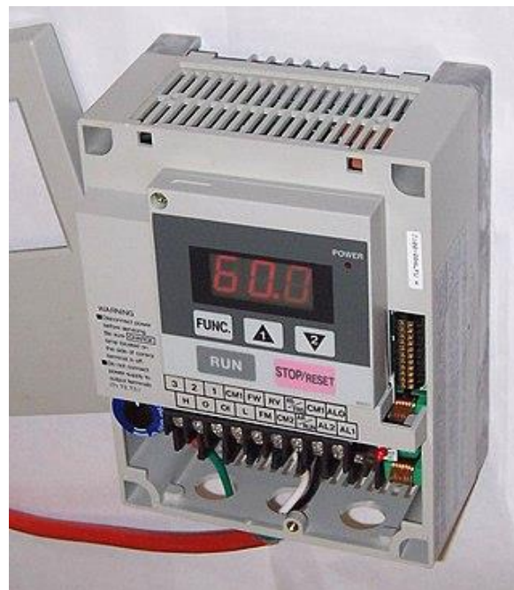
Figura 12: Ejemplo de un variador de frecuencia instalado en una pared.
