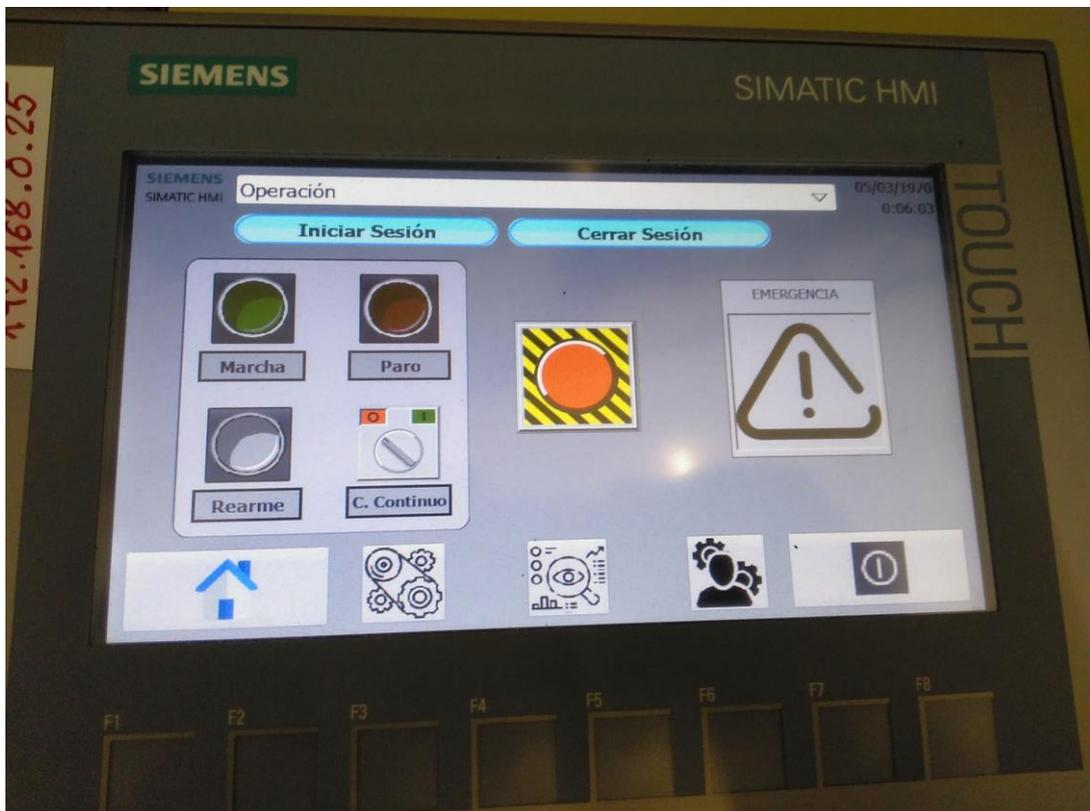
Figura 71: Máquina Parada por la Seta de Emergencia
