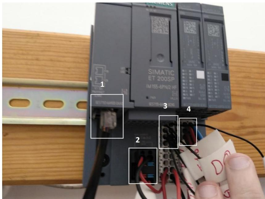
Figura 45: Conexiones ET200SP
