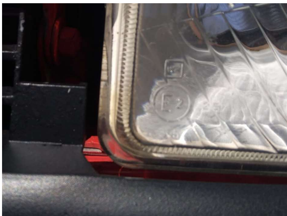
Ilustración 33 Homologación faro principal conductor Renault 5
