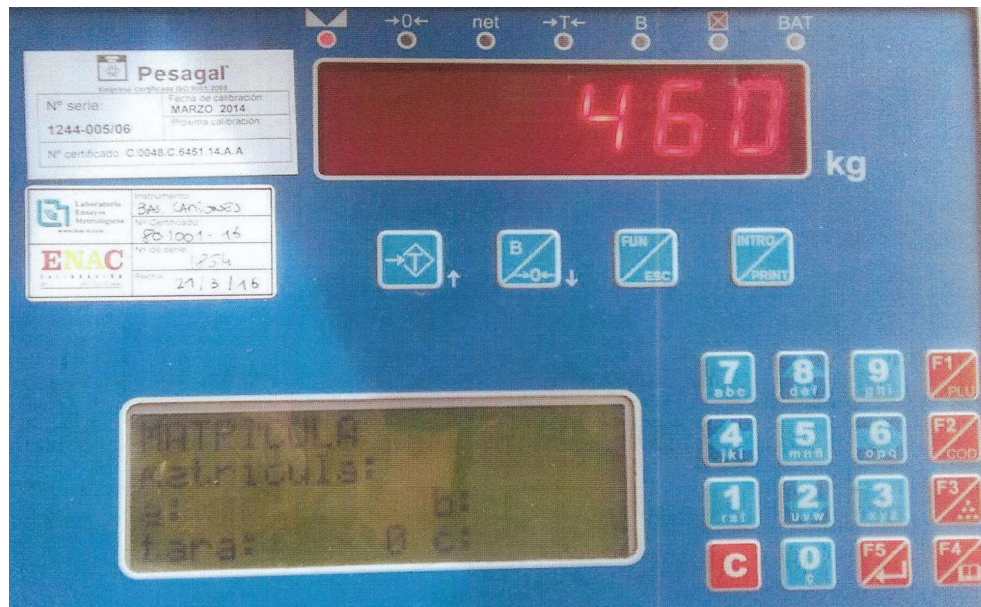
Ilustración 13 Peso en vacío del eje delantero
