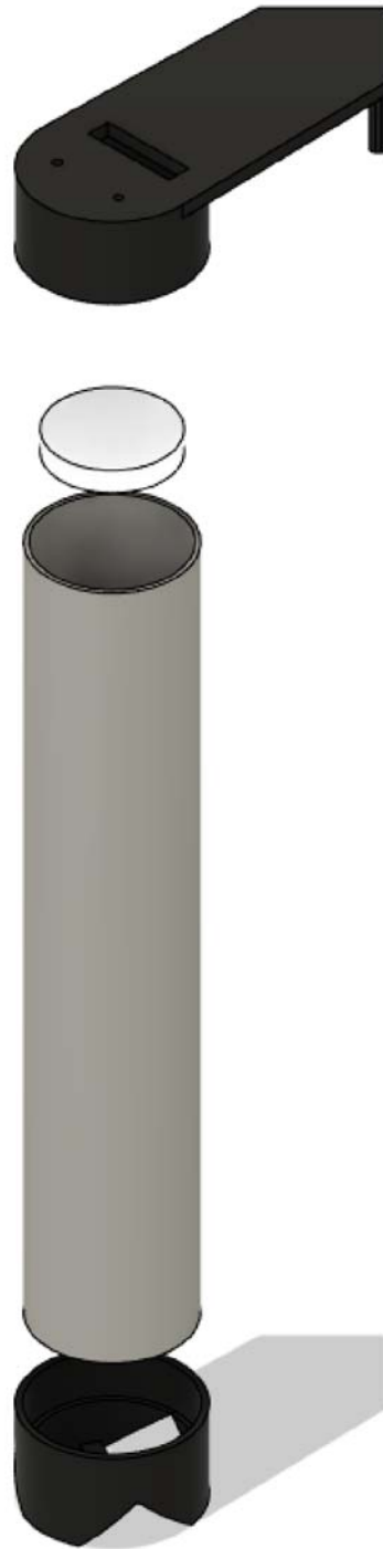
Figura 8.42 – Despiece del encapsulado del sensor
