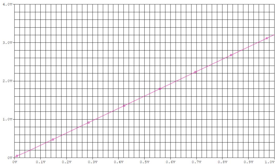
Figura 8.9 – Salida del circuito adaptador de 0÷1 V a 0÷3,3 V (ganancia 3,3)
