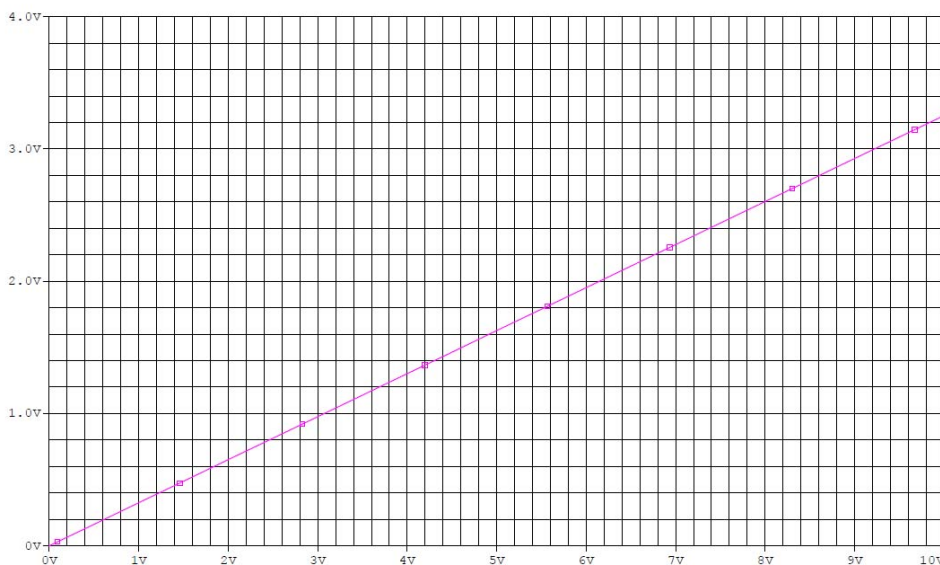
Figura 8.7 – Salida del circuito adaptador de 0÷5 V a 0÷3,3 V
