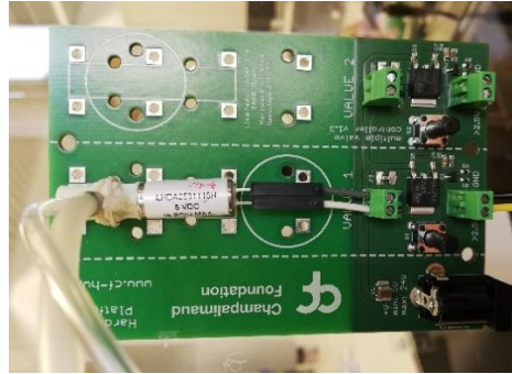
Figura 7. Válvula solenoide fixada en placa, conectada ao sistema de control da Raspberry Pi 4.
