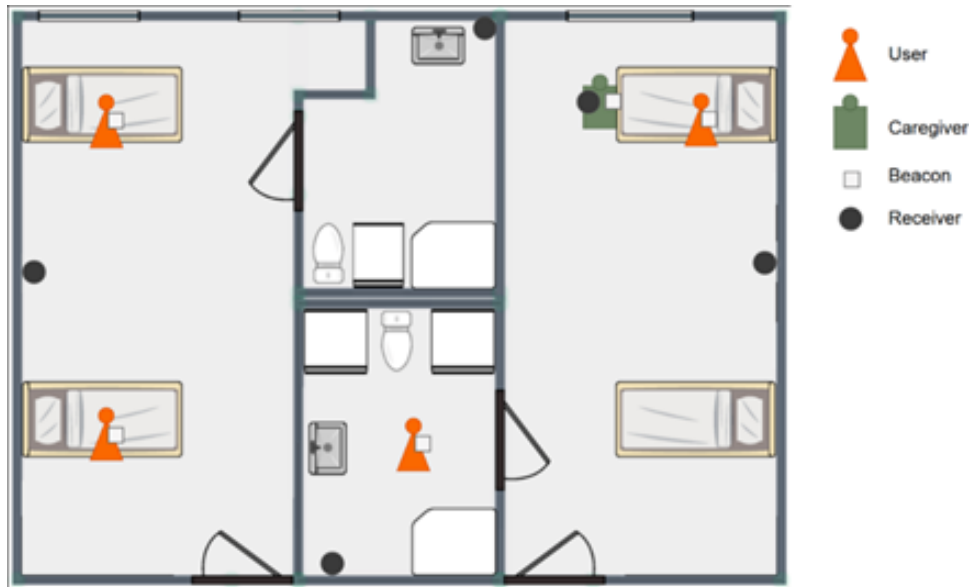
Figura 6.6: Colocación de receptores y beacons Bluetooth en Mayores
