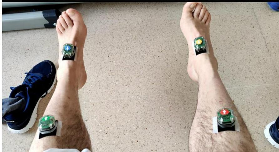
*Ilustración 7. Colocación de los sensores del dispositivo Bioval para determinación de los grados de pronación del pie a través del movimiento de la ASA*
