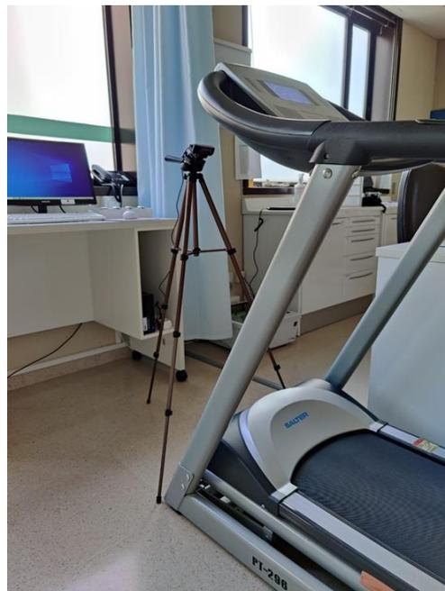
*Ilustración 6. Cámara Bioval Systems y tapiz rodante para mediciones.*
