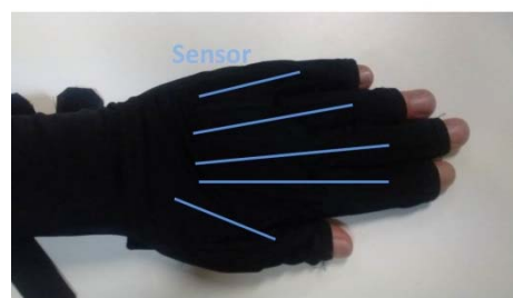
Figura 2. (a) Posición de los sensores en el guante 5DT de 14 sensores. (b) Posición de los sensores en el guante 5DT de 5 sensores.
