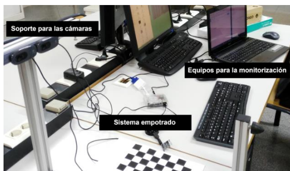
Figura 3: Instalación del sistema de visión estereoscópica.
