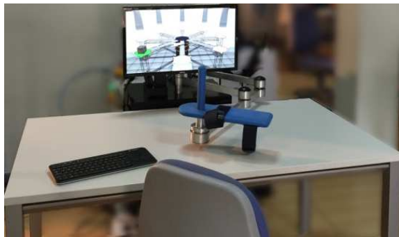
Figura 1: Sistema de neurorehabilitación basado en el robot PUPArm
