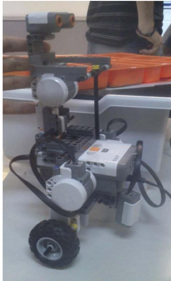
Figura 2: Robot NXT autobalanceable desarrollado por los alumnos
