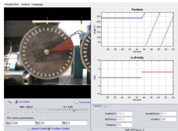
Figura 4. Planta del servomotor.
