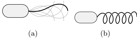
Figura 1: Mecanismos de propulsión de un flagelo artificial bacteriano: (a) Onda viajera (b) Helicoidal
