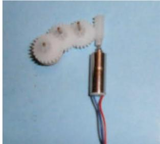
Figura 4. Tornillo sin fin y engranajes
