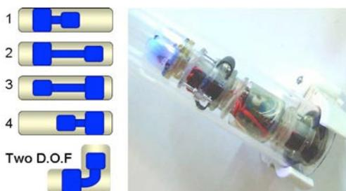
Figura 2. Módulo tractor tipo gusano
