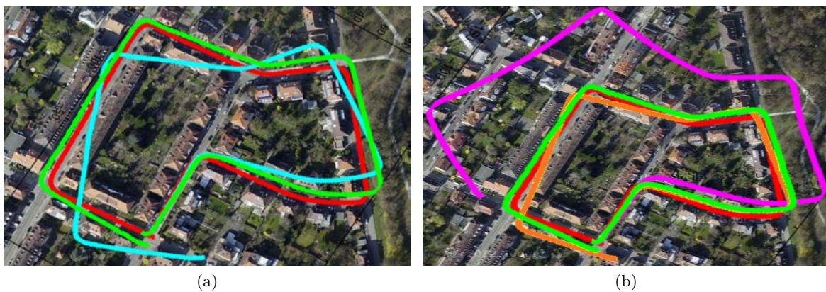
Figura 5: Trayectorias resultantes de la estimación de la odometría visual. (a) Comparación de la trayectoria obtenida sin la información de la desviación de la guiñada (línea cian) con la trayectoria autocalibrada (línea verde) y el ground truth (línea roja). (b) Comparación del efecto de ángulo de alabeo (línea naranja) y del ángulo de alabeo junto con el ángulo de cabeceo (línea magenta) en las trayectorias.
