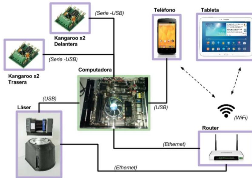
Figura 2: Conexiones entre los distintos elementos de Andábata.
