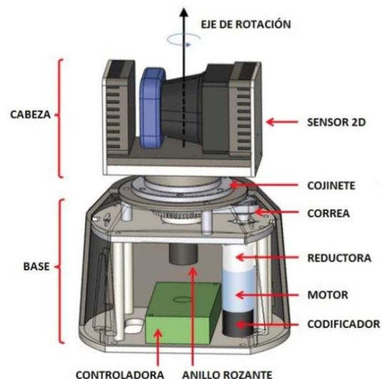
Figura 3: Principales componentes del escáner láser 3D.
