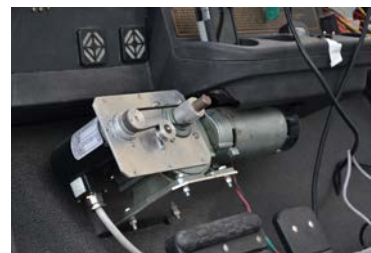
Figura 2: Sustitución del volante por sistema motor-encoder
