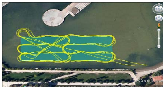
Figura 12. Resultado experimental de una exploración con nuestro USV
