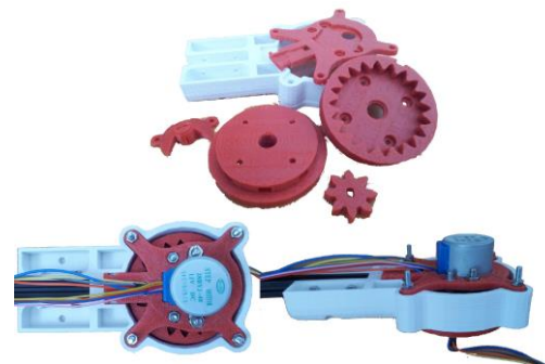
Figura 3: Piezas impresas y montaje del brazo con el casco.
