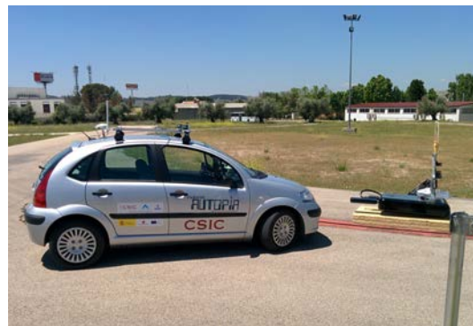
Figura 1: Vehículo del programa Autopia, instrumentado con nodos UWB, utilizado para realizar los test de posicionamiento.
