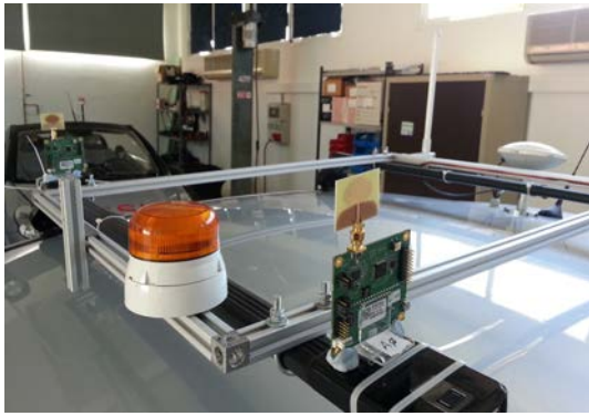
Figura 3: Detalle de la instalación de dos nodos UWB (anchors) sobre el frontal del techo del vehículo. Obsérvese la posición retrasada de la antena GPS.
