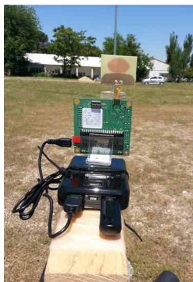
Figura 2: Detalle de uno de los nodos UWB de Decawave (tags) distribuidos por el entorno de test.
