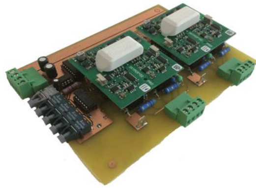
Figura 15: Placa de adaptación de fibra óptica a señal para los IGBT.
