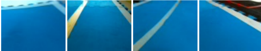
Figura 6.6: Vista de la cámara del robot en Seguir Carril con clasificación en circuito azul: (de izqda a derecha) etiquetas recibidas de recto lento, recto rápido, derecha e izquierda.
