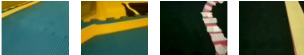
Figura 6.12: Seguir Carril con regresión en circuitos de carril único y esquinas redondeadas: vista de la cámara del robot A (dos primeras imágenes) y del robot B (dos últimas imágenes).
