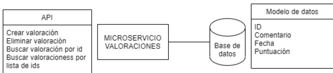
Figura 7.6: API y modelo de datos del microservicio valoraciones
