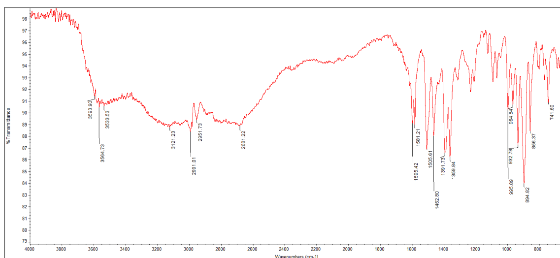
Figura 81.- Espectro de infrarrojo para el complejo L 2c : \nu(\text{NH}) a 3564\text{ cm}^{-1} , \nu(\text{C}=\text{N}) a 1595\text{ cm}^{-1} , \nu(\text{C}=\text{C}) entre 1391\text{--}1581\text{ cm}^{-1} , \nu(\text{C}-\text{O})_{\text{coord}} a 1359\text{ cm}^{-1} y \nu(\text{V}=\text{O}) a 933\text{ cm}^{-1} .
