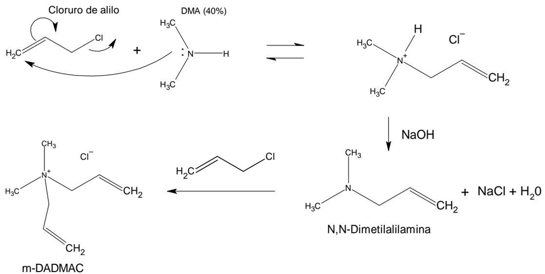
Figura 3.-Síntesis del m-DADMAC (Adaptado de Boothe, 1969).
