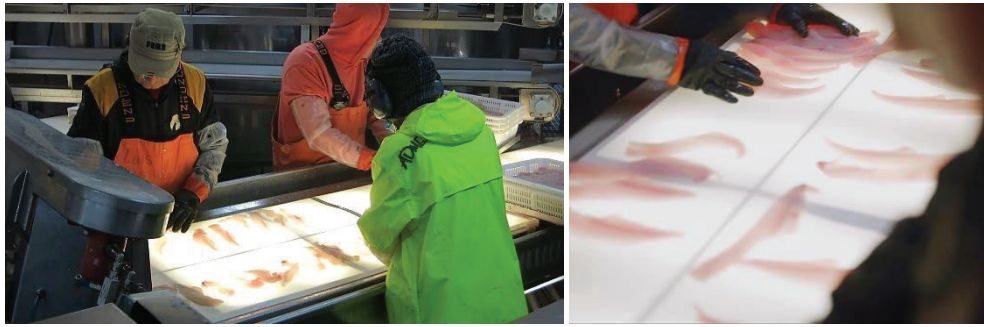
Figura 5. Proceso de inspección al trasluz ( candling ) llevado a cabo en una empresa dedicada a la comercialización de filetes de pescado sin piel. Imágenes tomadas de https://carsoe.com/seafood-processing/products/candling-tables/ .
