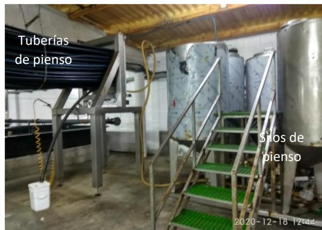
Ilustración 15: sistema automático de alimentación. A la izquierda vemos la disposición del alimentador en uno de los tanques, a la derecha silos de pienso y tuberías del alimentador
