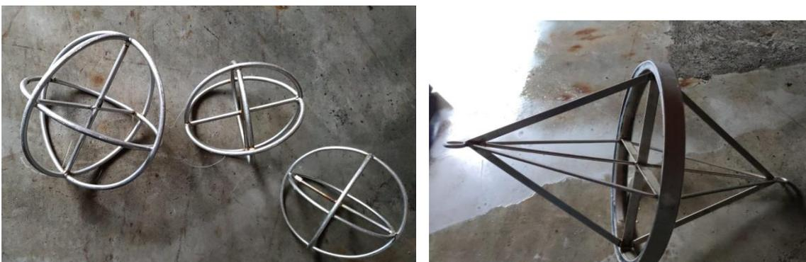
*Ilustración 23: izquierda bolas de limpieza de las líneas pequeñas, derecha bola de limpieza de la línea principal, diámetro de unos 80 cm*
