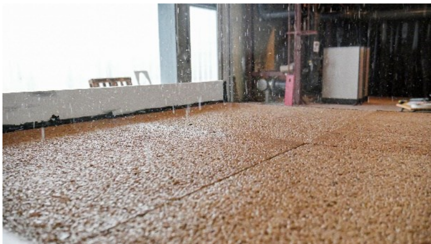
Figura 18. Precipitación de 80 mm/h en la losa permeable
