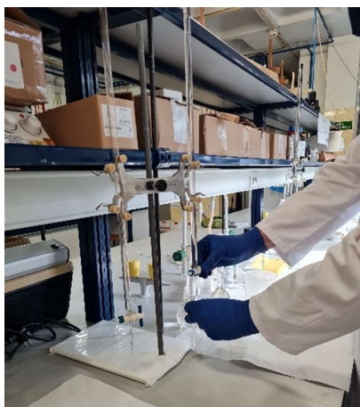
Figura 5. Adición agua de mar sobrecargada
