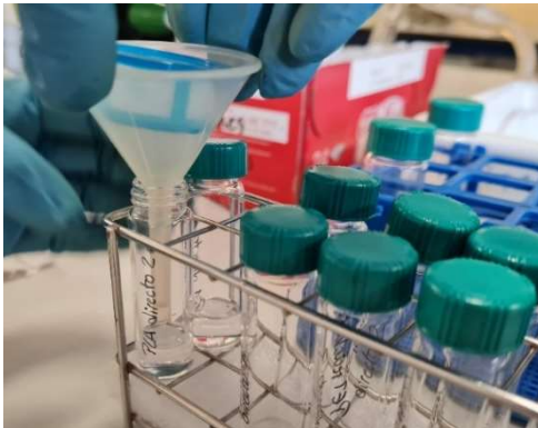
Figura 8. Filtración del extracto ácido de desorción
