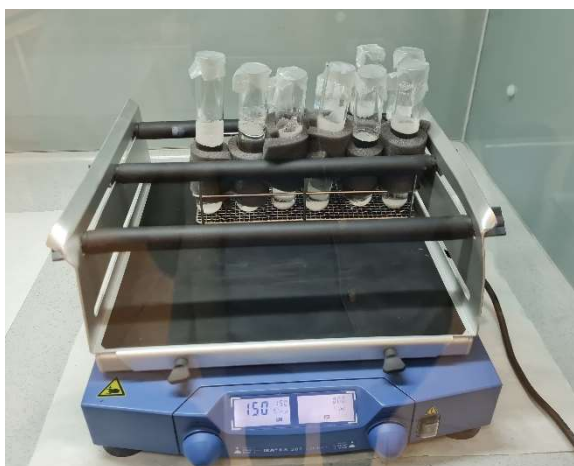
Figura 6. Ensayo de adsorción en agitador orbital-vaivén
