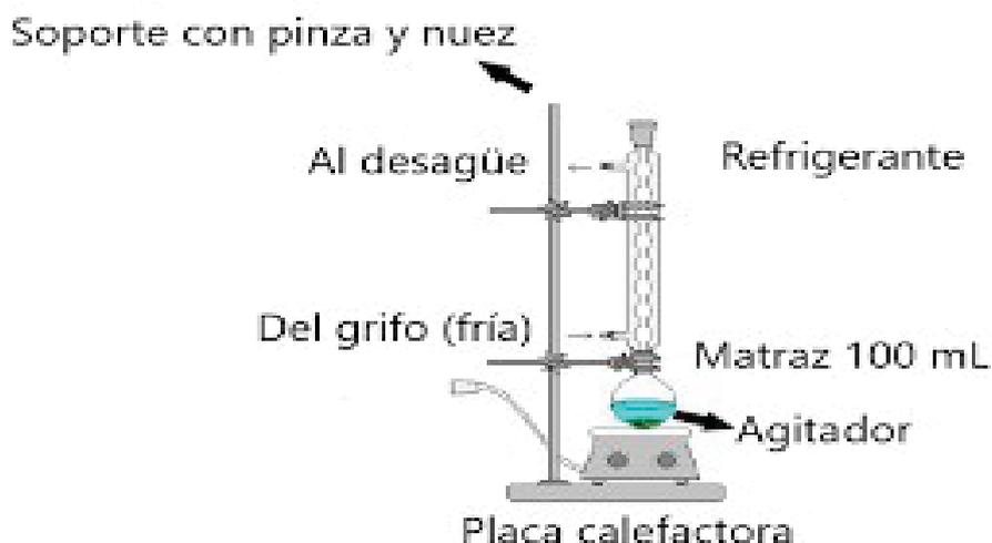
**Figura 25.** Montaje de reflujo.
