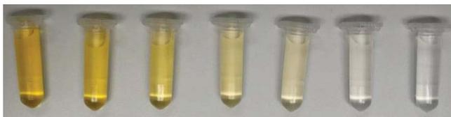
**Figura 3.** Imagen de las disoluciones seriadas de red box, 0,5; 10, 50, 100, 200, 500 y 1.000  $\mu\text{M}$
