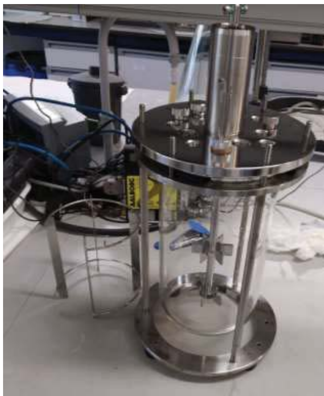
Figura 9. Reactor antes de montar 29
