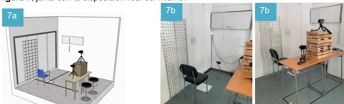
Figura 7. Disposición del set de medición fotogramétrico (7a: esquema tridimensional; 7b: disposición real del set).
