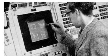
Fig 3 , Computadora TX-2 con el dispositivo light pen.
