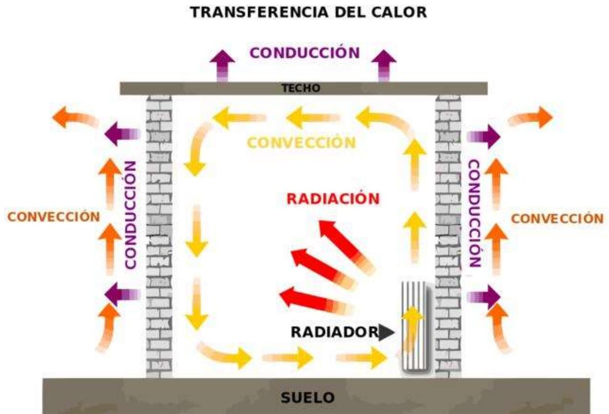
Figura 5.1.1 - Formas de transferencia de calor. Fuente: (Wikipedia, 2011)
