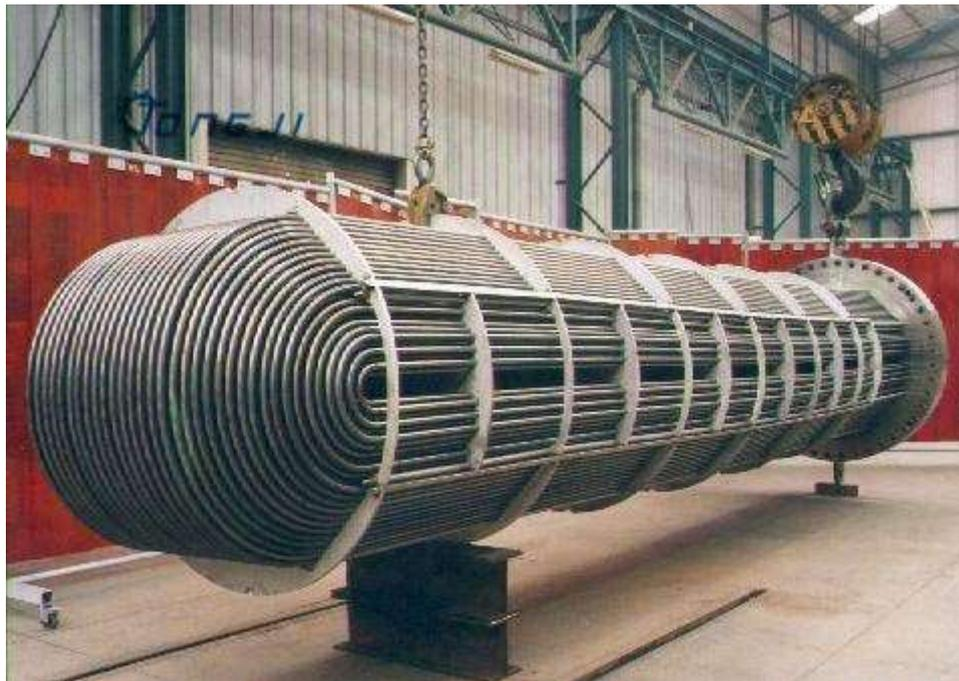
Figura - 6.2.2.2 Haz de tubos en "U" sin la carcasa. Fuente: (Zhangjiagang Maitan Metal Products Co., Limited, s.f.)
