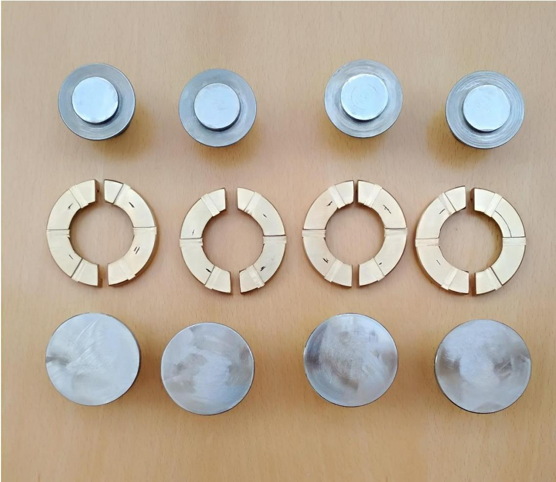
*Figura 17: Útiles para los ensayos de tracción*
