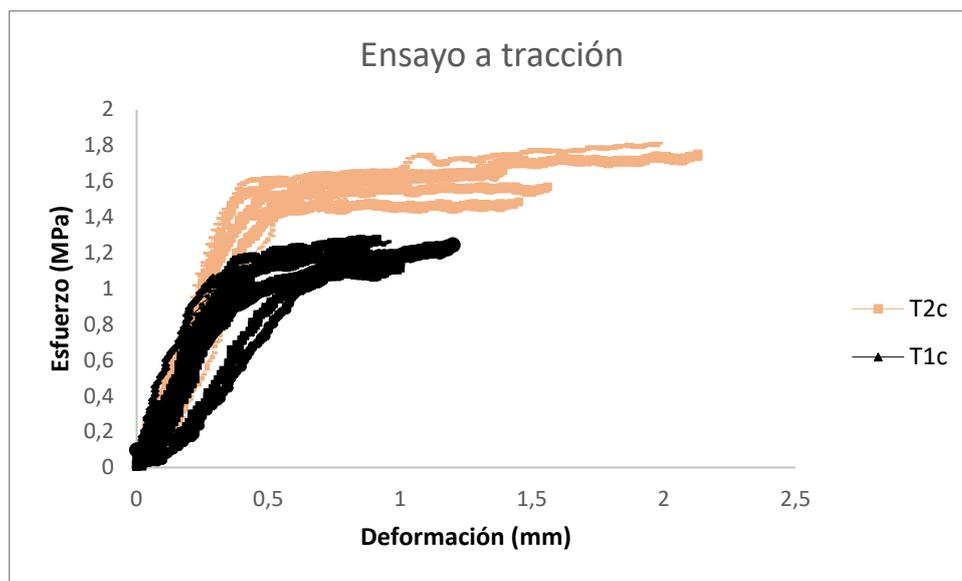
Figura 51: Diagrama esfuerzo-deformación de los ensayos de tracción de uniones creadas con los adhesivos T1c y T2c
