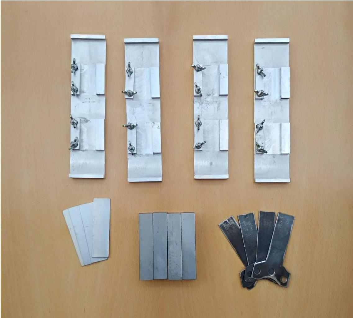
*Figura 13: Útiles para los ensayos de cizalla*
