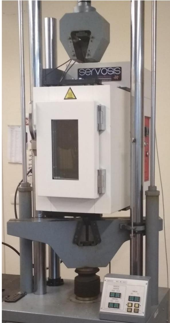
*Figura 23: Estufa acoplada a la máquina universal de ensayos*
