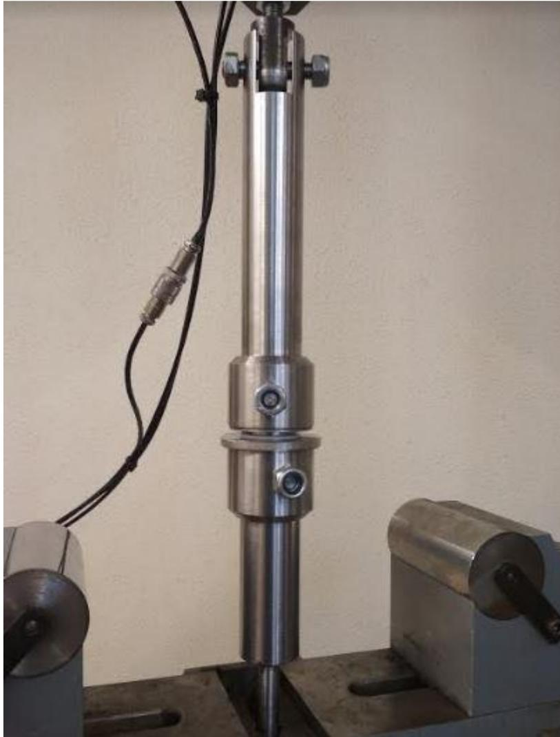
*Figura 22: Colocación de las probetas unidas en la mordaza adaptada para el ensayo de tracción*
