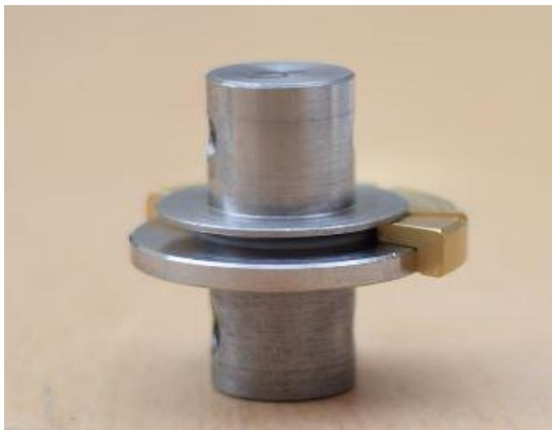
*Figura 19: Probetas unidas mediante un espesor de 1 mm de adhesivo*
