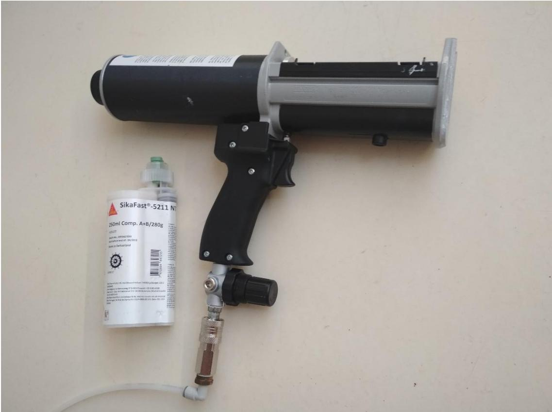
*Figura 11: Pistola neumática para la aplicación del adhesivo SF*
