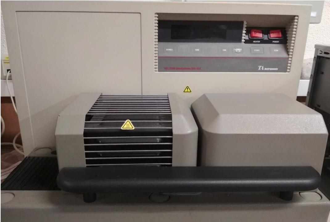
Figura 6: Analizador térmico simultáneo
