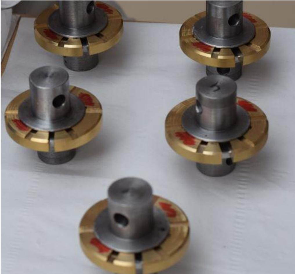
*Figura 18: Sistema de control del espesor del adhesivo en la unión de las probetas que se ensayan a tracción*
