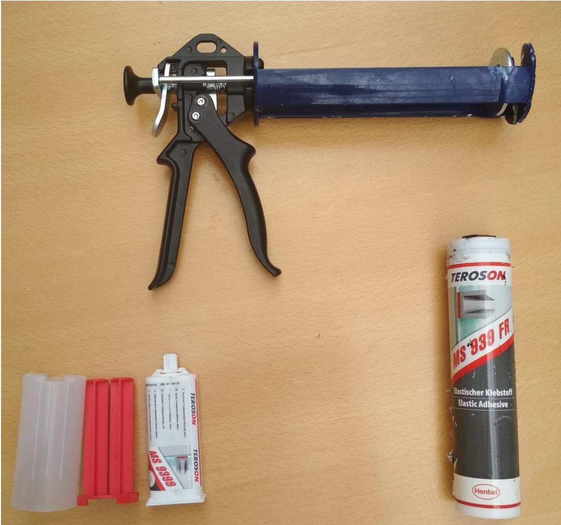
Figura 12: Pistola manual para la aplicación de los adhesivos T1c y T2c
