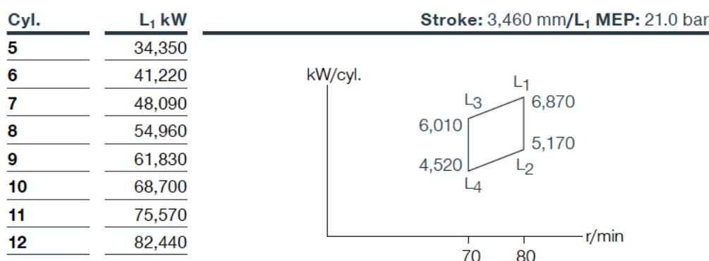
En primera instancia, y dados los resultados obtenidos en la predicción de la potencia, servirá el motor de 11 cilindros.
