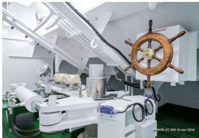
► Equipo de servo timón entregado por Hidramarin.
