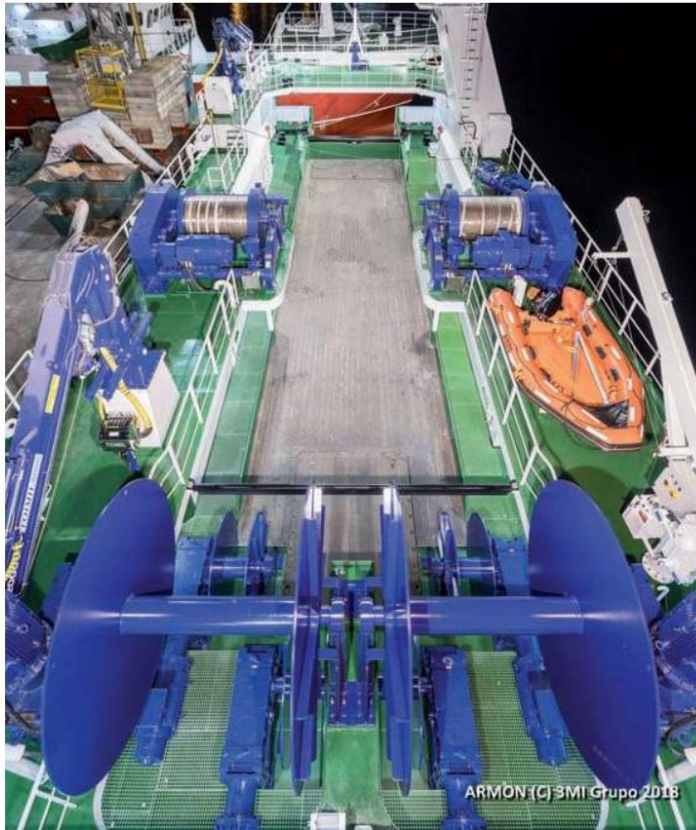
► Las maquinillas y tambores de Ibercisa, con su característico azul, mueven los aparejos de arrastre del "Oshiveli".
