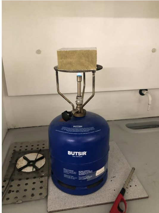
Figura 29: Ensayo al fuego.
