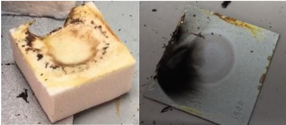
Figura 39: Probeta de Airex, ensayo al fuego.
