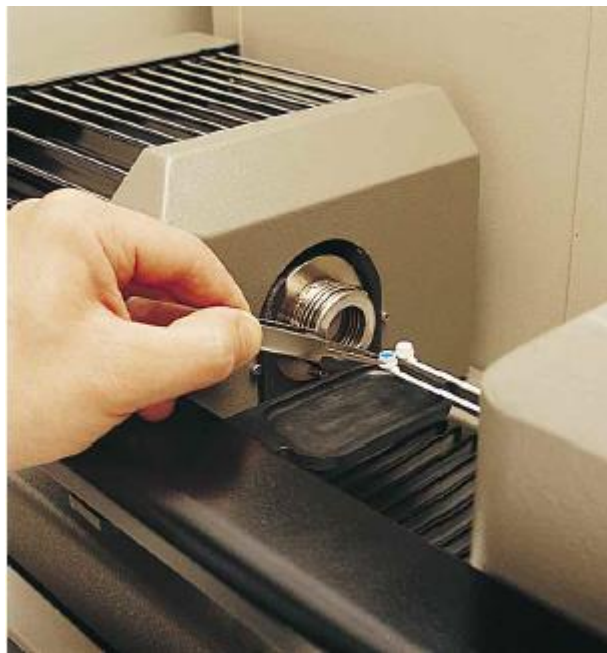
Figura 19: Colocación de las cápsulas en su posición de trabajo [12].
