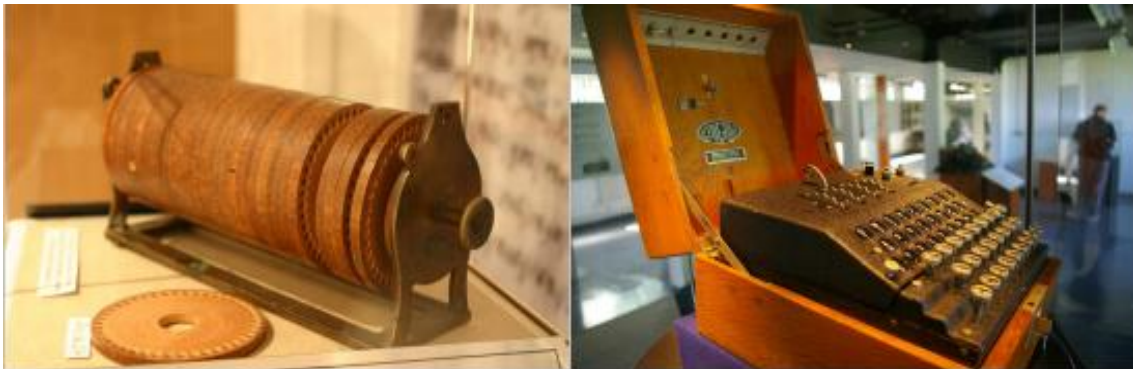
Figura 3: Mecanismos de criptografía de la Segunda Guerra Mundial: rueda de cifrado y máquina Enigma
