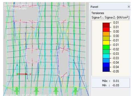
Gráfico extraído de RFEM que muestra las direcciones principales de las tensiones ante el peso propio
