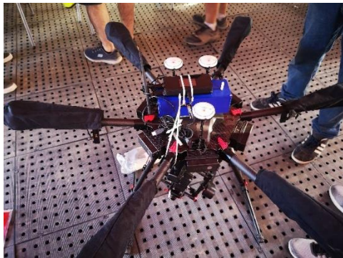
Figura 7: Nodo sensor montado en dron
