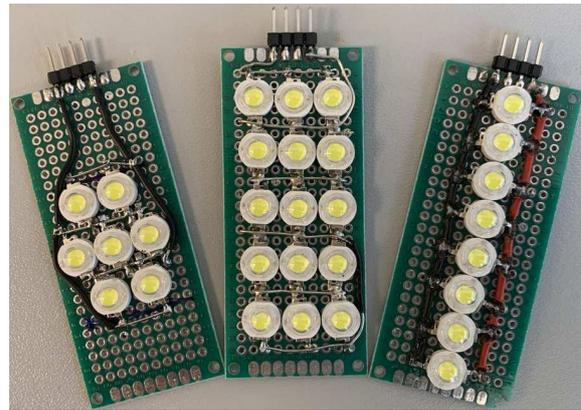
Figura 4: Placas modulares del sistema de iluminación inferior
