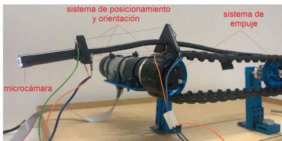
Figura 1: Prototipo de catéter autónomo (imagen real)
