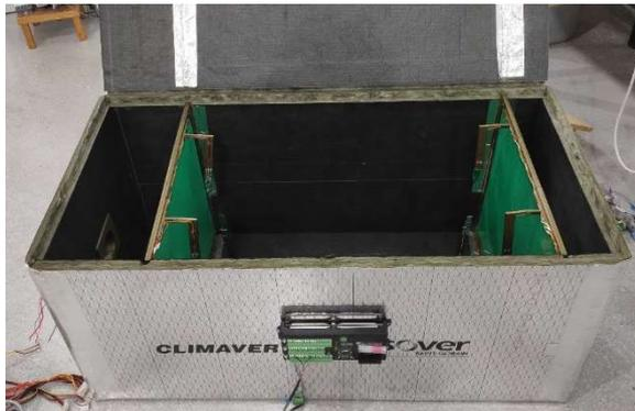
Figura 6: Cámara climática con sensores, actuadores y controlador/registrador.
