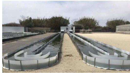
Figura 1: Reactores raceway (Centro IFAPA).
