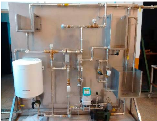
Figura 5: Planta de control de nivel con intercambiadores
