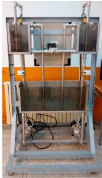
Figura 4: Planta de control de nivel doble
