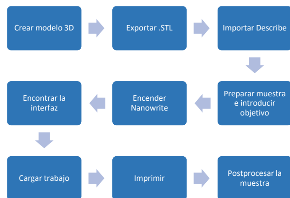
Figura 3: Esquema del flujo de trabajo de la impresora
