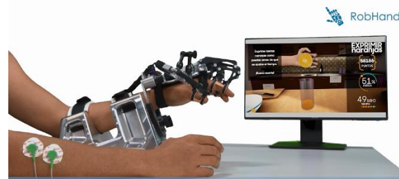
Figura 4: Realización de una terapia bilateral basada en EMG utilizando un entorno virtual
